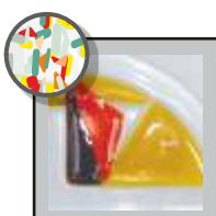
**Geschmolzenes Glas (Fusing)** – weist auf der Oberfläche plastische Motive auf, welche mittels Einschmelzen verschiedenfarbiger Glasstücke in das Basisglas gebildet werden.
